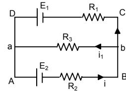
$$iR_3R_1 + i_1R_2R_1 + i_1R_2R_3 = E_1R_2 - E_2R_1$$
